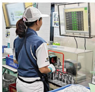
最終工程の検査は製品を置くだけで瞬時に寸法を測定する画像測定器で全数確認
