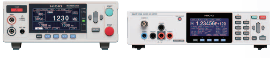
使用測定器：絶縁抵抗試験器 ST5520 (左) 超絶縁計 SM7110 (右)
